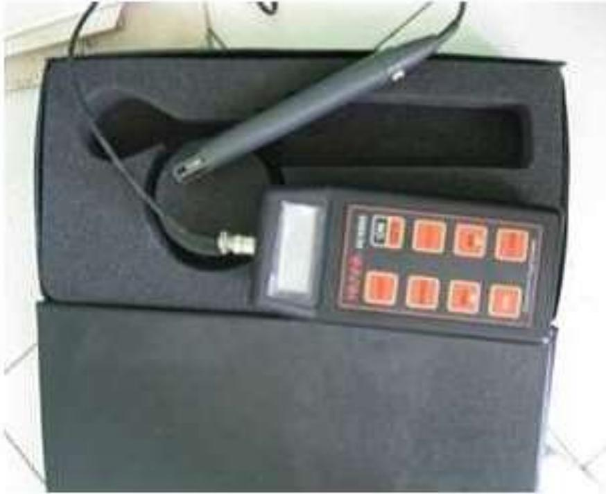
Gambar A.4. Termohygrometer
