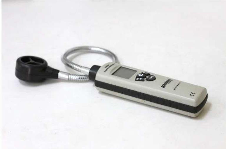
Gambar A.3. Anemometer
