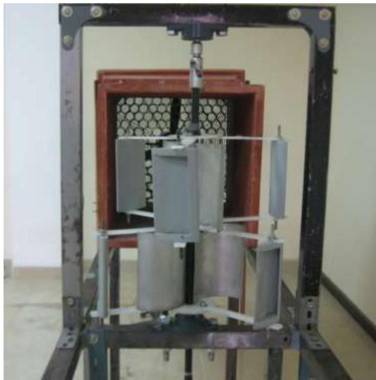
Gambar 9. Model Turbin Angin bilah Hibrid Dua Tingkat Tanpa Wind Deflector
